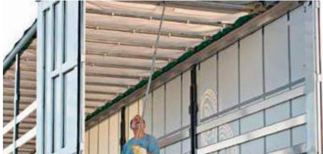
Zesilovací pásy pro pevné a posuvné střechy autoplachet.
