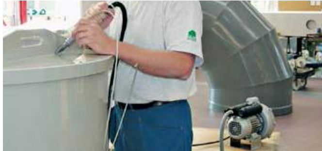
Dmychadlo ROBUST slouží jako zdroj vzduchu pro ruční přístroj WELDING PEN.
