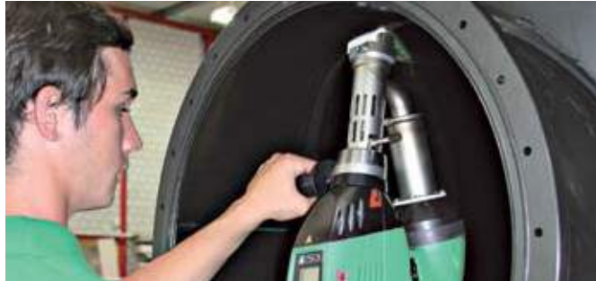
WELDPLAST S2 svařuje snadno i vnitřní rádius.
