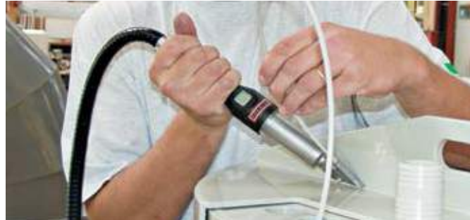
Svařování drátem pomocí kompaktního a lehkého přístroje WELDING PEN R.
