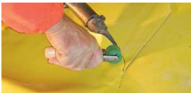
PŘÍTLAČNÝ VÁLEČEK svařování průmyslových tkanin.
