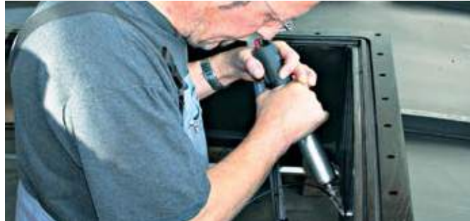
Pohodlné svařování s lehkým, ale velmi výkonným přístrojem DIODE PID.
